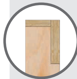
Ausgelenkter Wandständer mit durchgehendem Fenstersturz und Rähm
