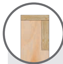
Ausgelenkter Wandständer mit durchgehendem Rähm
