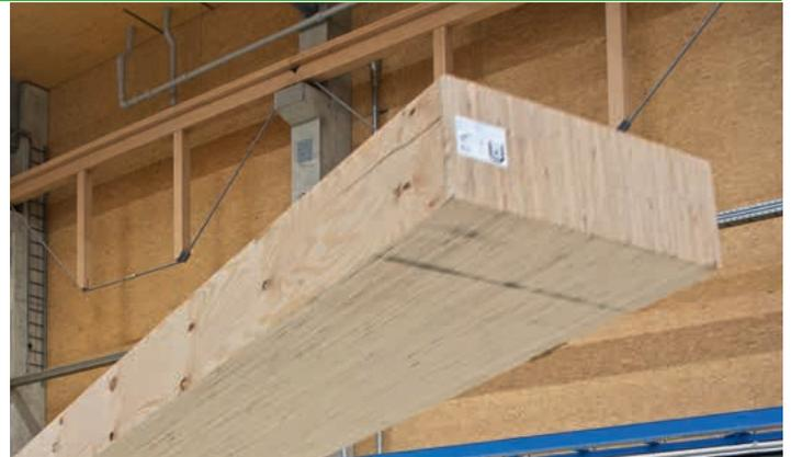
Weil die Anforderungen bei verschiedenen Anwendung recht unterschiedlich sind, stellt STEICO sein Furnierschichtholz in zwei Varianten her: STEICO LVL R und STEICO GLVL R mit allen Furnierlagen in Faserrichtung sowie STEICO LVL X und STEICO GLVL X mit teilweise quer verklebten Furnierlagen.
