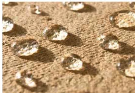
Während der Bauphase können die Dämmplatten bis zu 4 Wochen der Witterung ausgesetzt werden – genügend Zeit für den Putzauftrag.
